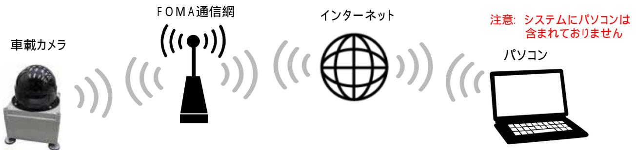
車載カメラからの画像信号はFOMA回線を経由してインターネットに接続され、インターネットに接続したパソコンで監視、操作が可能です。
