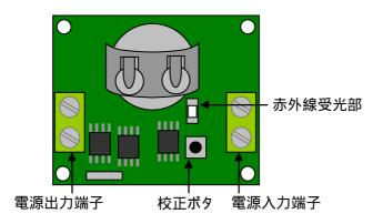
電源入出力端子をACアダプタ、LED表示ユニットなどにそれぞれ接続して使用し、付属のソフトにより設定した1日8回までの電源ON-OFF動作を行います。
